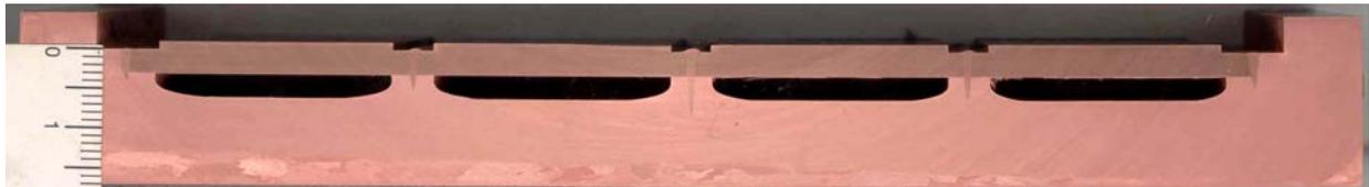
1.800 mm lange SE-Cu Kühlplatte im Querschnitt Bild 2
