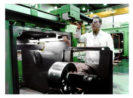
4-axes manipulator 'oszillant'
